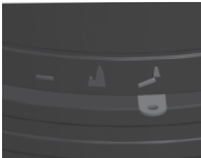
Abb. 4.7 Verbrennungsluftschieber: ganz rechts - Luft ganz geöffnet
