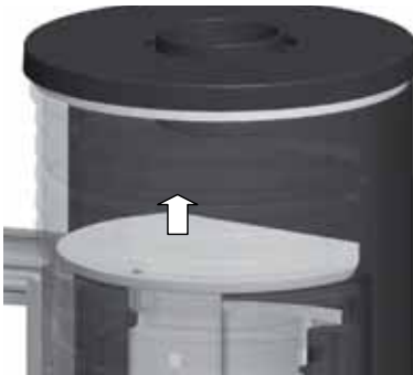
Abb. 4.20 Gussmulde über die Arretierung heben und...
