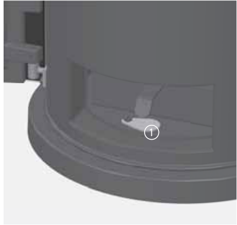
Abb. 4.8 Brennstoffwähler geschlossen, Betrieb mit Holz
