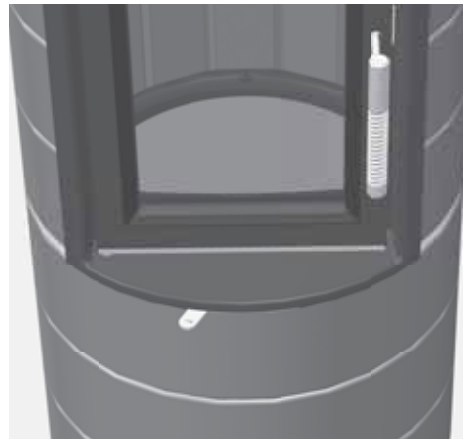
Abb. 4.6 Verbrennungsluft-Schieber, links, ganz geschlossen
